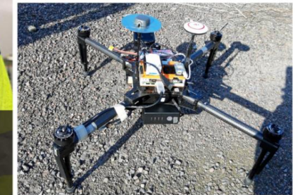
I forskningsprosjektet som Ranvei Isaksens og Bjørn Lupton Aarseth er en del av brukes det droner for å overvåke og avdekke feil i solcellepaneler. FOTO: UIO
