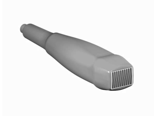
Figur 4: Bilde av ultralydprobe for kardiologi. Kabelen kommer ut øverst til venstre og er koplet til ultralydinstrumentet. Fronten av proben er på ca 20 x 15 mm og det er vist oppdeling i noen få individuelle stavelementer. I praksis er det mellom 48 og 128 slike elementer
