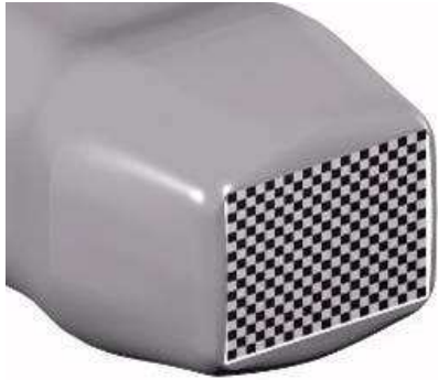
Figur 17: Skjematisk bilde av ultralydprobe for 3D avbildning med et matrisearray.
