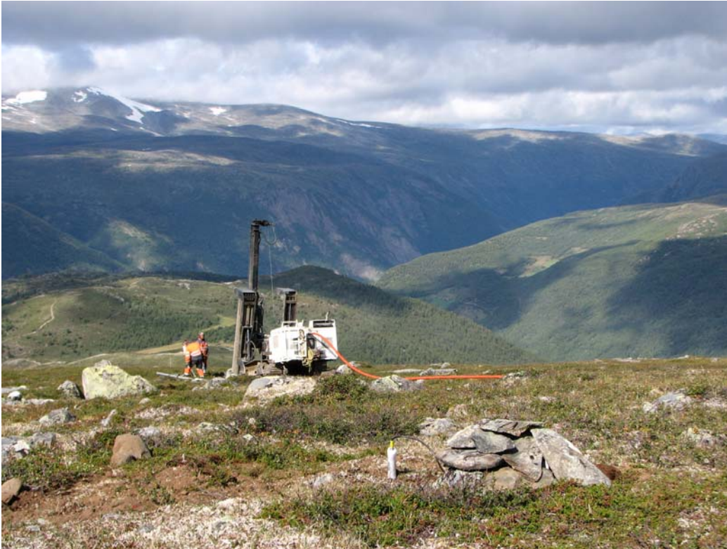
SOIL-2 setup (forgrunn). Måledybder: 8.5, 17, 25.5, 34, 51 og 85 cm
