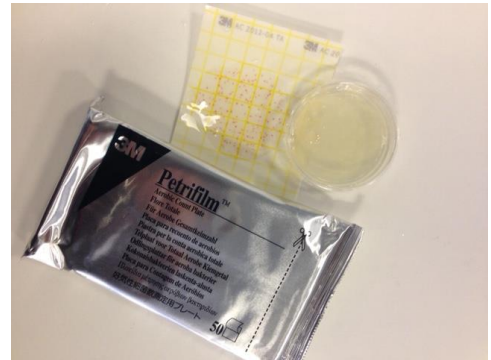
Figur 1: Petrifilm er svært enkelt å bruke. Bilde viser petrifilm med bakterievekst, og en petriskål med næringsagar uten bakterievekst. Petrifilm og næringsagar kan kjøpes hos læremiddelfirma.
