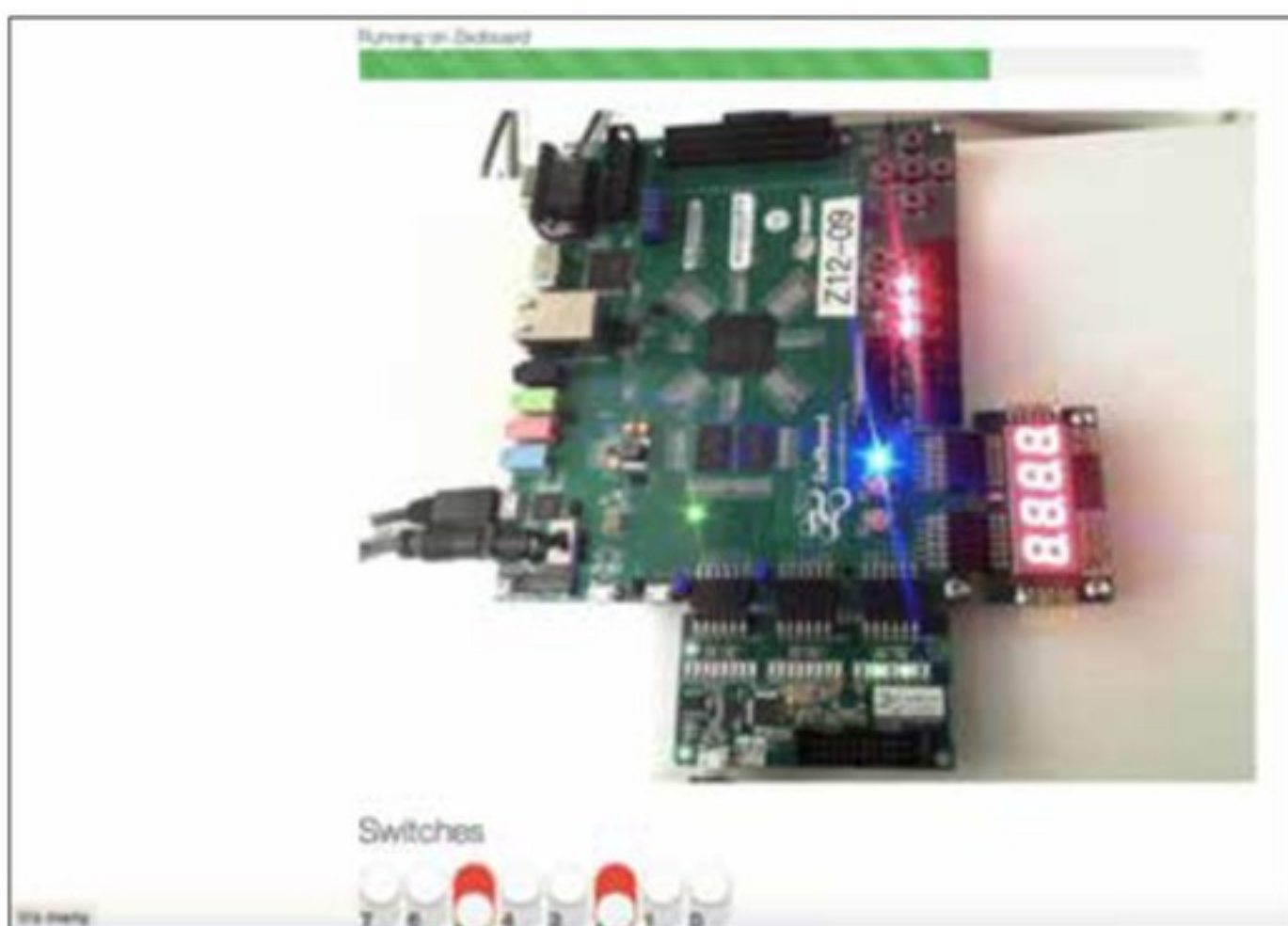
Figur 2. Skjerm bilde over hvordan det ser ut å teste en løsning i fjernlaben. Kort for fjernstyrte brytere ses plugget i hovedkortet nederst på bildet.
