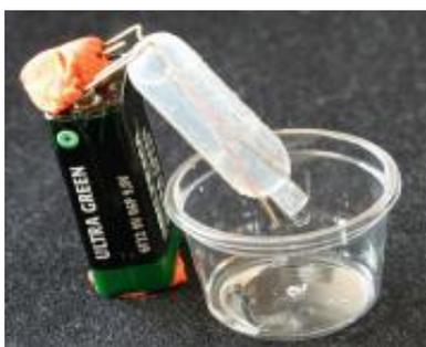
4. Forbind de to bindersene med hver sin elektrode på batteriet, samtidig som dråpetelleren holdes over begeret, se bildet. Klem bindersene ned mot kontaktene på batteriet. Observer og noter hva som skjer ved de to elektrodene.
