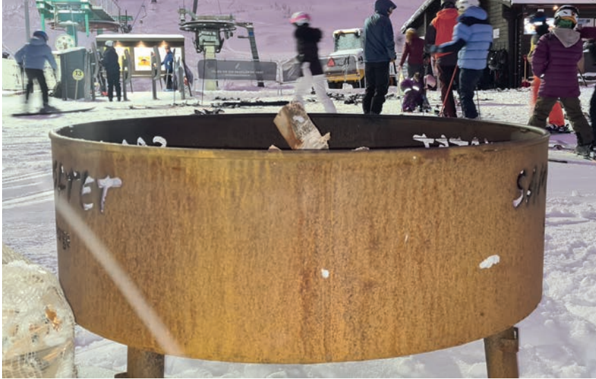
Figur 2. Korrosjon kan være en ønsket kjemisk reaksjon, slik som her på en bålpanne av jern. Foto: Jan Höper
