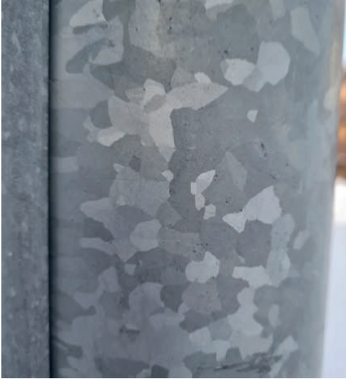
Figur 3. Jernstolper er ofte beskyttet ved et sinkbelegg, som kjennes igjen på krystaller i ulike størrelser. Foto: Jan Höper
