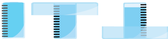
Figur 2. Illustrasjon av hvordan måleglasset fylles og blir snudd opp ned.
